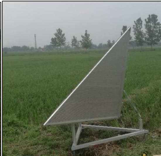
A.2 角反西向实物图片
